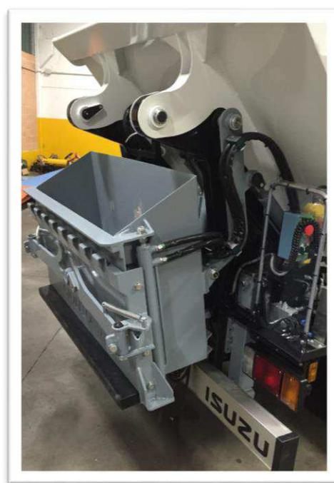
Le unità utilizzate come *automezzi satellite* nella raccolta rifiuti, al pari di quelle impiegate nello spazzamento manuale e nel diserbo dovranno inoltre essere dotate di doppio sportello laterale di carico (uno per lato della vasca).
