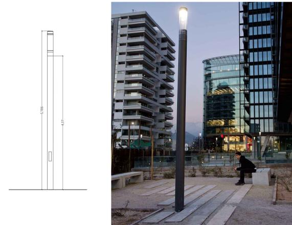
L01 - Prospetto corpo illuminante di progetto tipo Schröder Shuffle 360 - 5116 | scala 1:50
