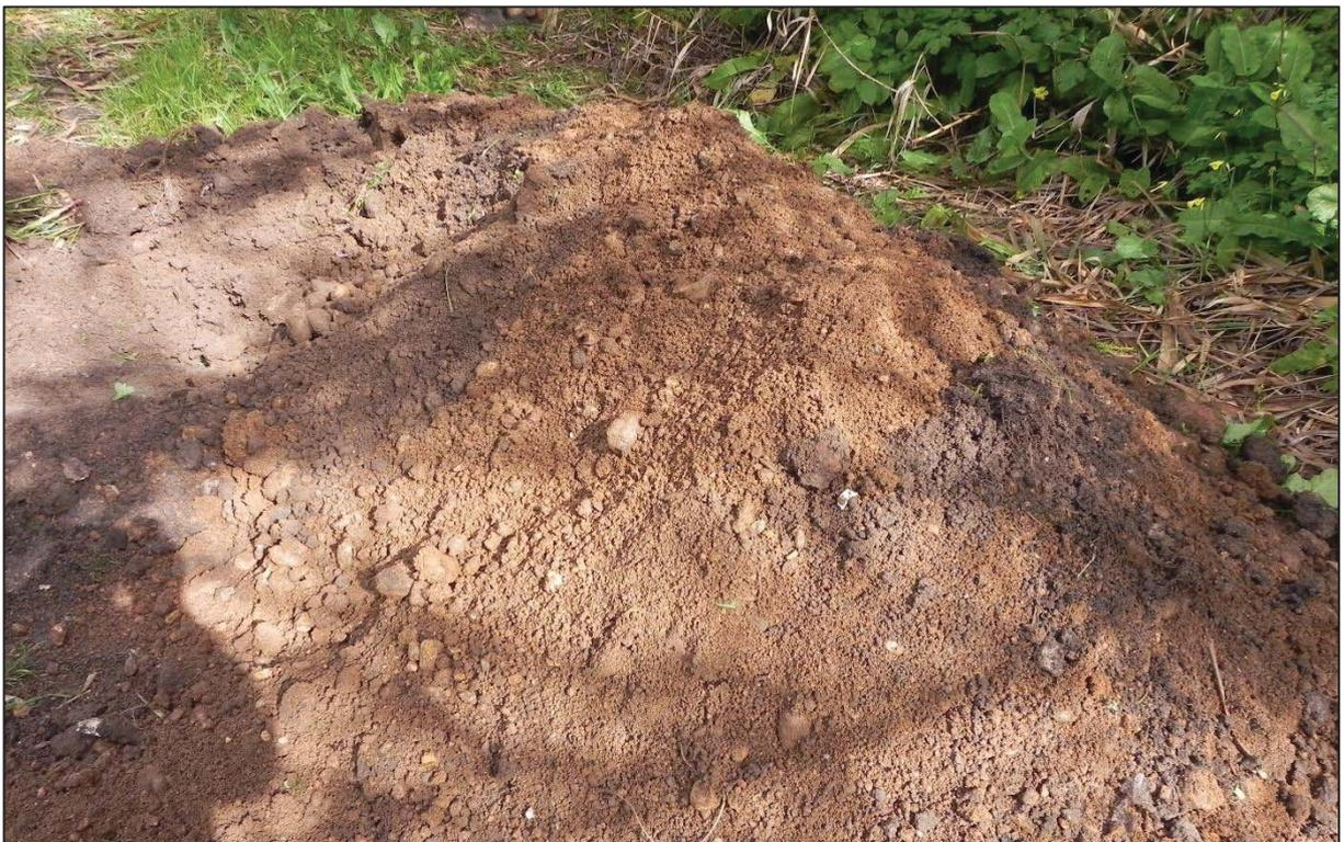
**FOTO 2.4** – Sabbione rimaneggiato rinvenuto nel pozzetto PZ2 (spessore minimo 1,00 m).
