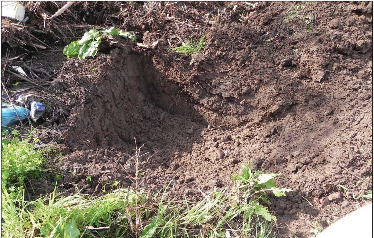
**FOTO 2.3** – Suoli sabbioso-limoso rimaneggiati rinvenuti nel pozzetto PZ1 (spessore minimo 1,50 m).
