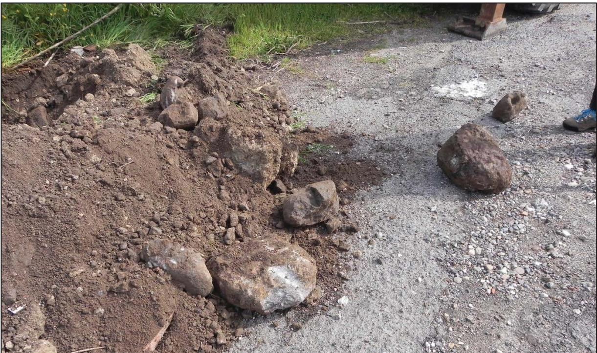
**FOTO 2.1 e 2.2** – Terre della massiciata stradale rinvenute nel pozzetto PZ3 (spessore 0,80 m).
