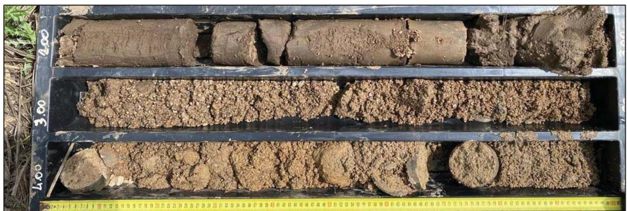
**FOTO 2.5 e 2.6 – Sequenza alluvionale rinvenuta nei sondaggi (spessore minimo 6,00 m).**
