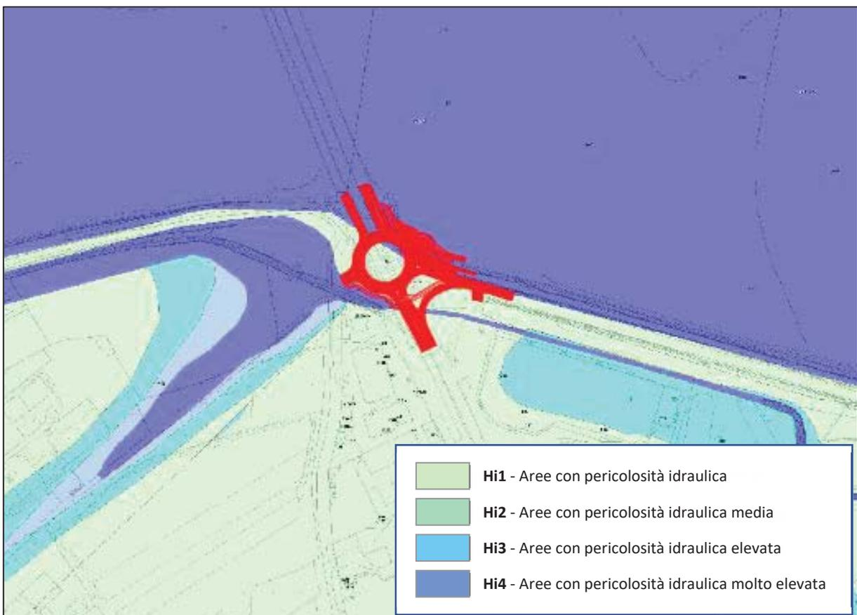
**FIGURA 4.2** – Stralcio cartografia della pericolosità idraulica secondo l'art. 8 comma 2 delle N.A. del P.A.I.
