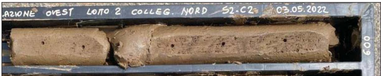
FOTO 2.16 – Fori residui delle prove eseguite con pocket penetrometer.
