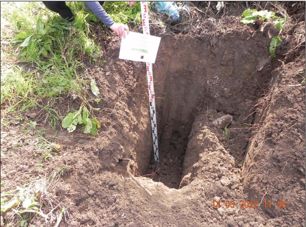
FOTO 2.4 e 2.5 – Realizzazione dei pozzetti con acquisizione della stratigrafia dei terreni.
