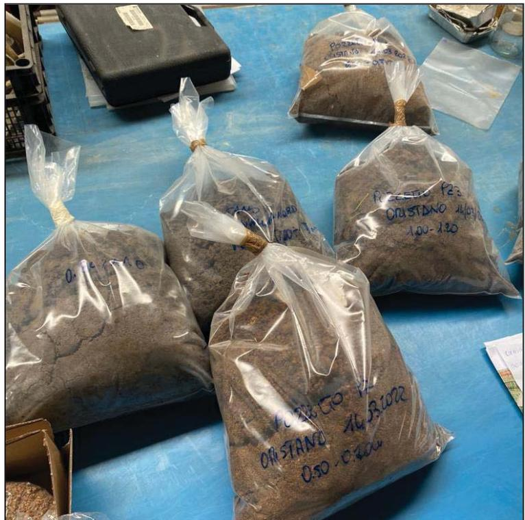
FOTO 2.11 e 2.12 – Campioni prelevati da sondaggio (a sinistra) e da pozzetto (a destra).
