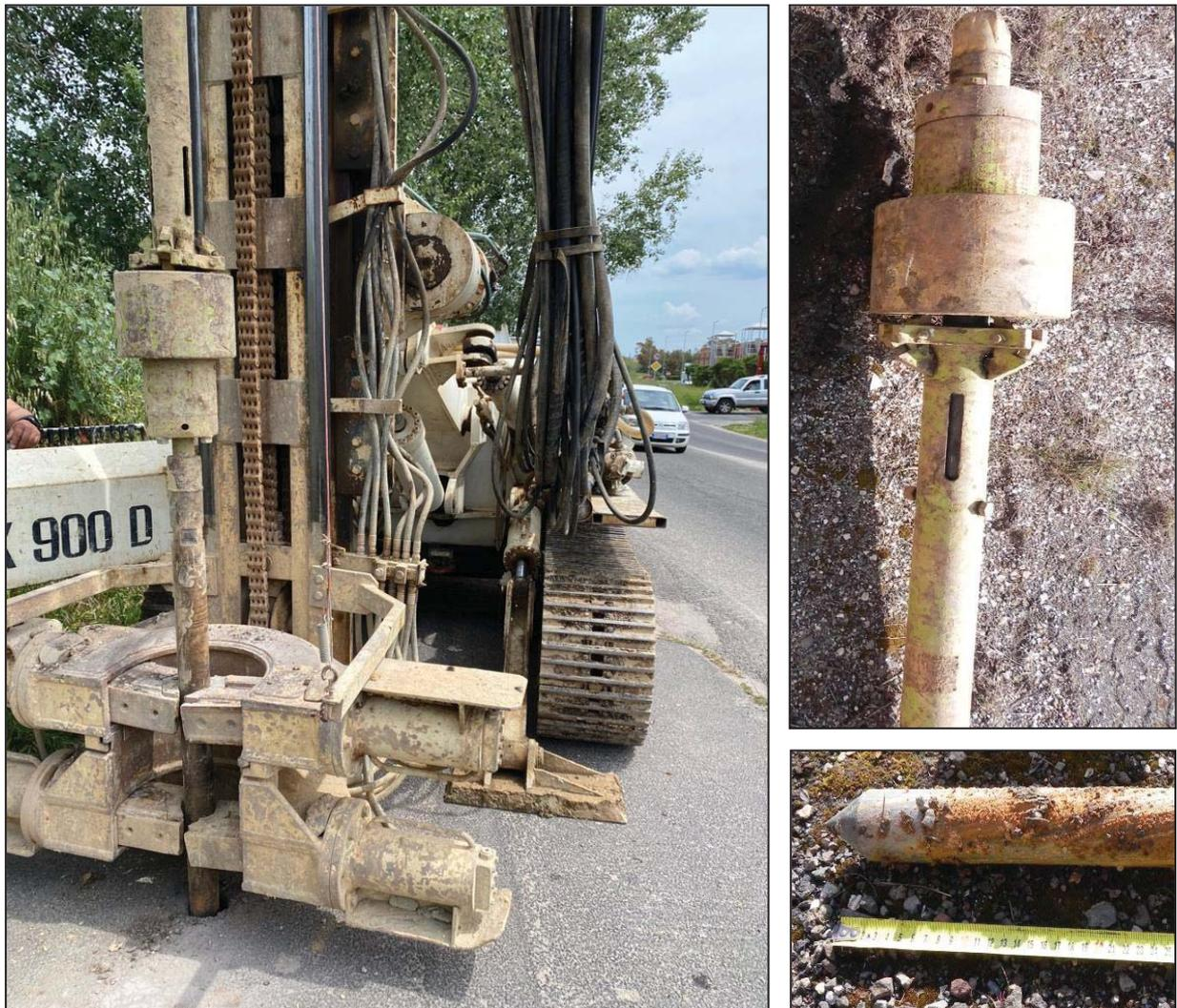
FOTO 2.13, 2.14 e 2.15 - Fasi di esecuzione dello Standard Penetration Test.
