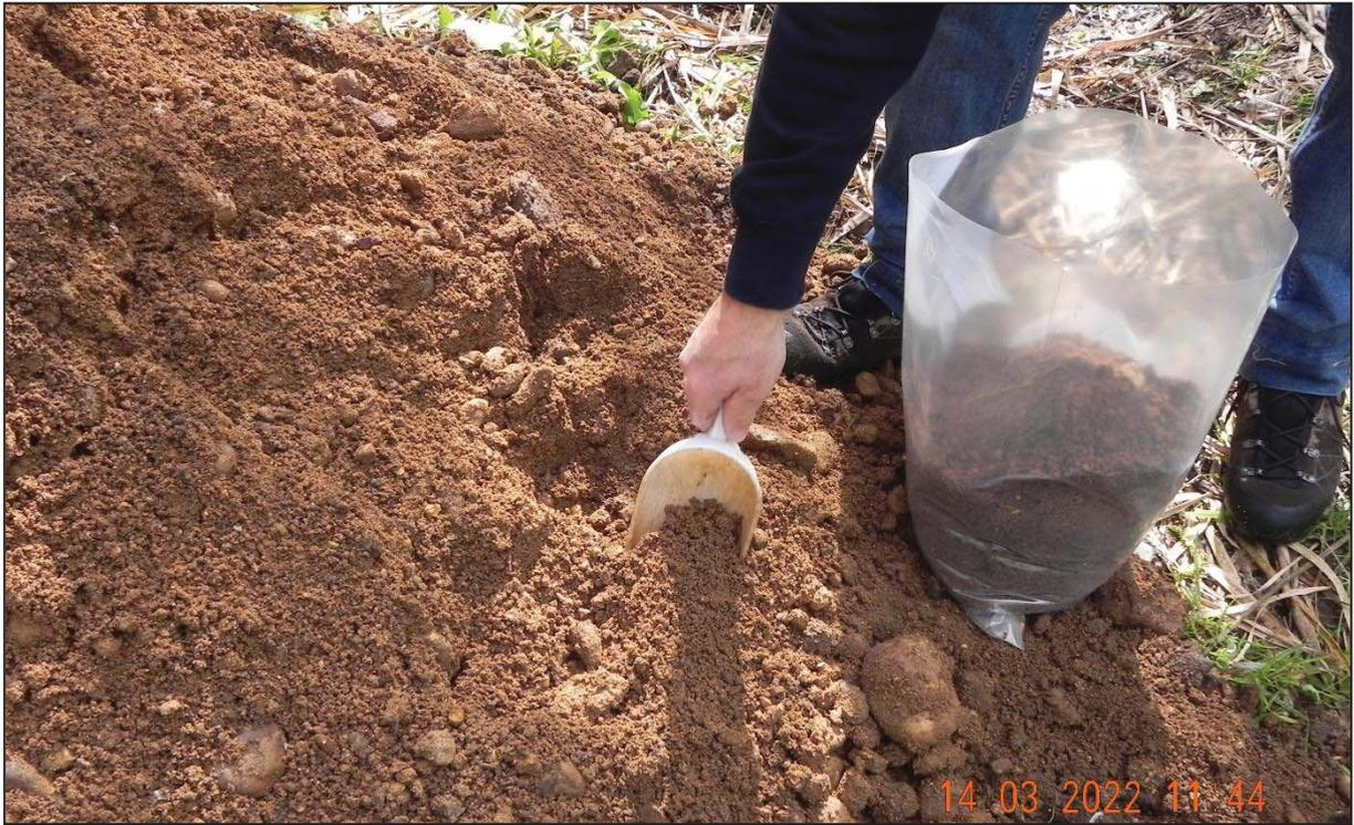
FOTO 2.10 – Operazione di campionamento dei terreni da pozzetto stratigrafico.
