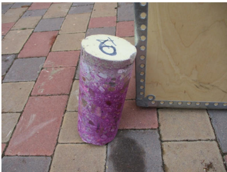
Particolare carota prelevata
