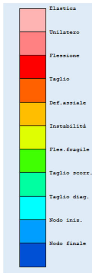
Legenda verifiche di sicurezza in condizioni sismiche
