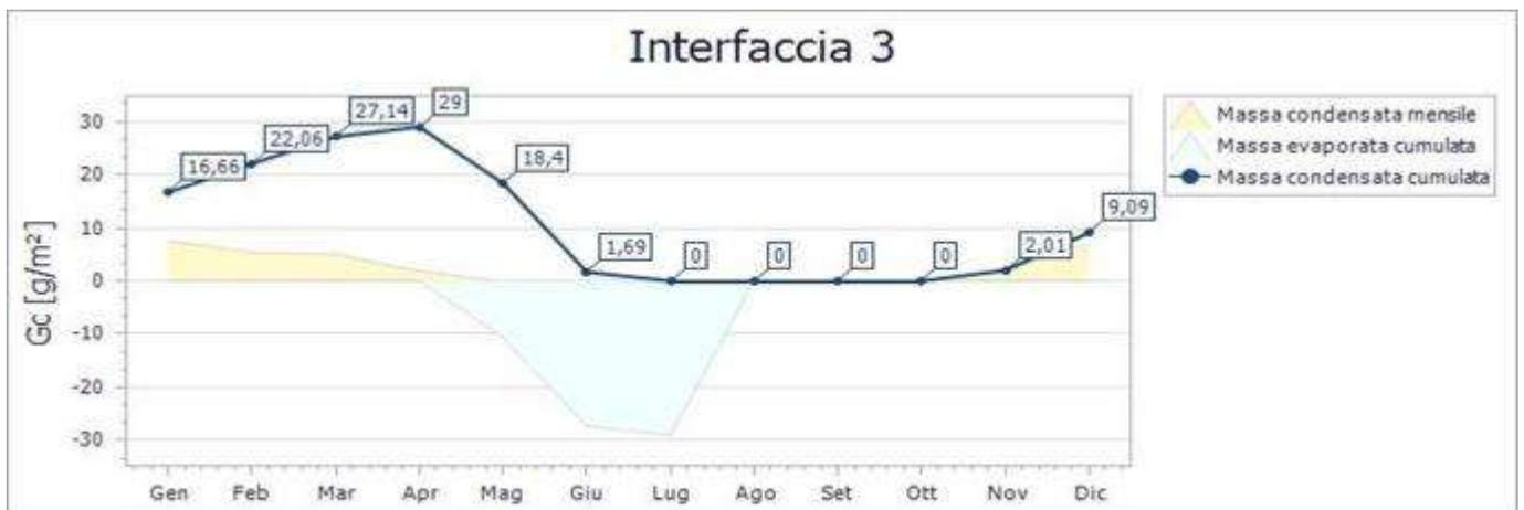
Quantità max. di condensansa accumulata in un'interfaccia
