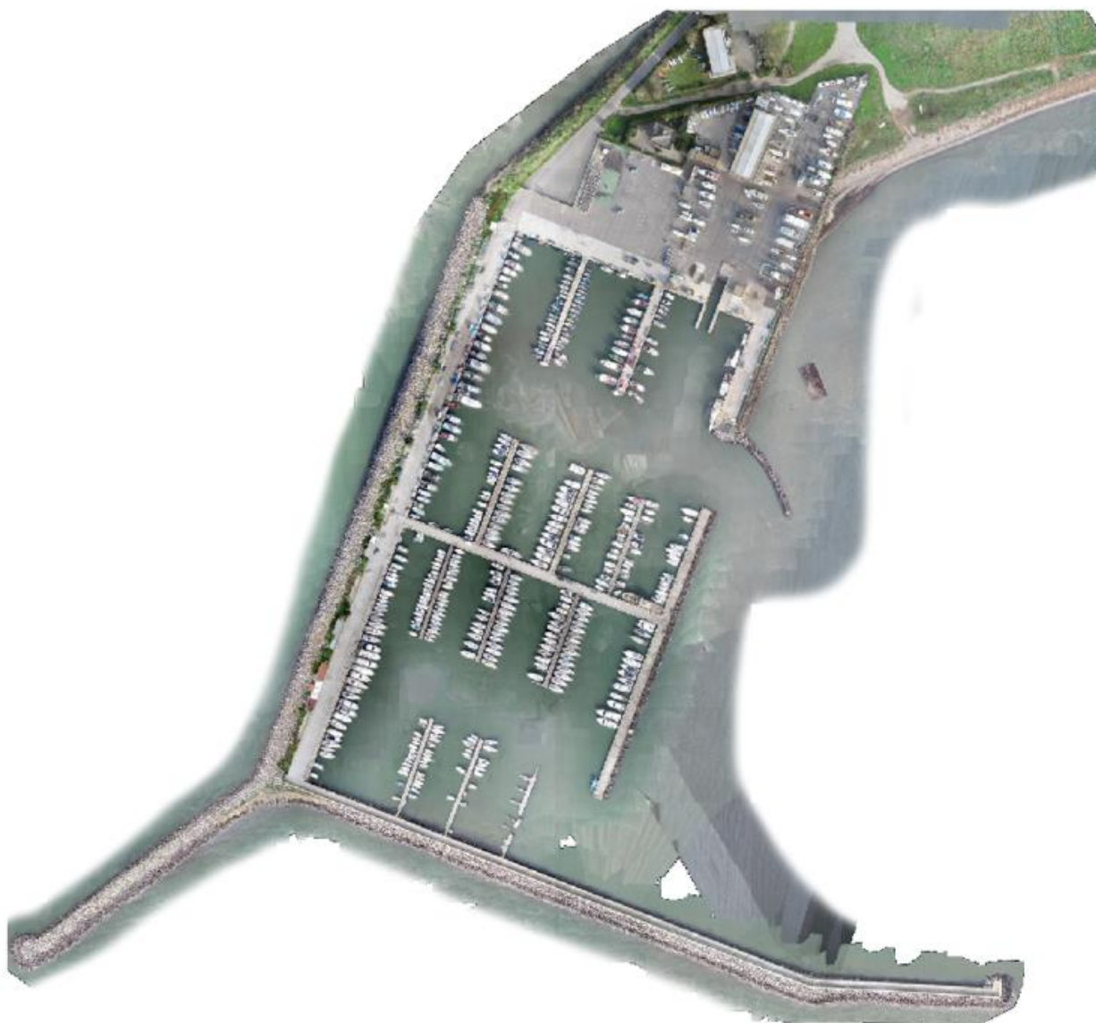
Figura 5 - aerofotogrammetria generata da n. 2160 foto
