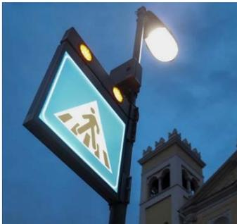
L'illuminazione del piano orizzontale è fondamentale per evidenziare l'attraversamento con un valore minimo consigliato di 100 lux medi ed andando ad illuminare il piano verticale si garantisce un ottimale illuminamento del corpo dei pedoni rendendoli visibili già dall'area d'attesa, fondamentale per la prevenzione degli incidenti. I corpi illuminanti che saranno utilizzati dovranno avere le medesime caratteristiche tecniche e normative di quelli utilizzati per l'illuminazione pubblica.
