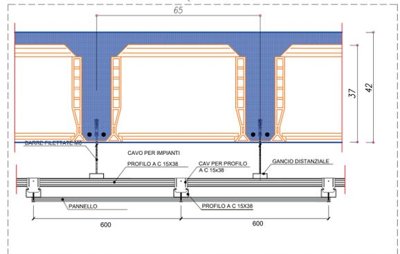
Particolare Solaio e Controsoffitto - Scala 1:10
