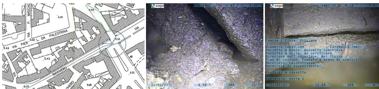
Fig. 11 – Planimetria progetto del '00 condotta via Ricovero che allontana le portate dalla piazza, stato caditoie.
