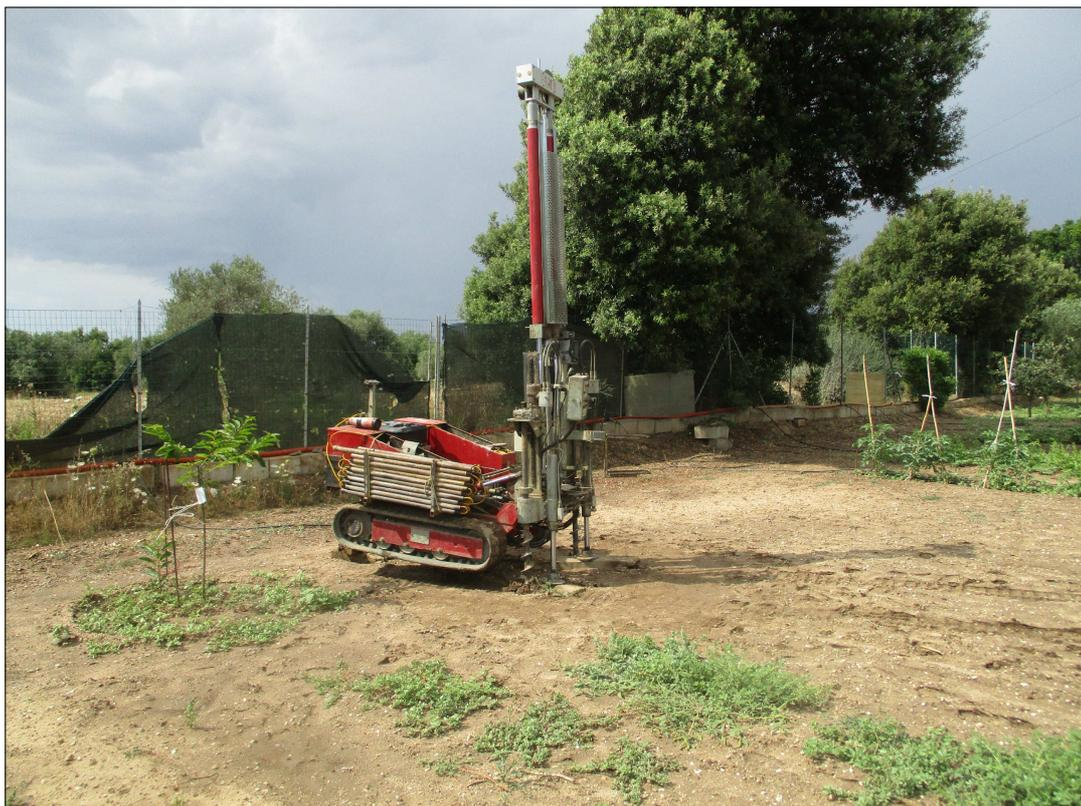
**PROVA PENETROMETRICA STATICA
