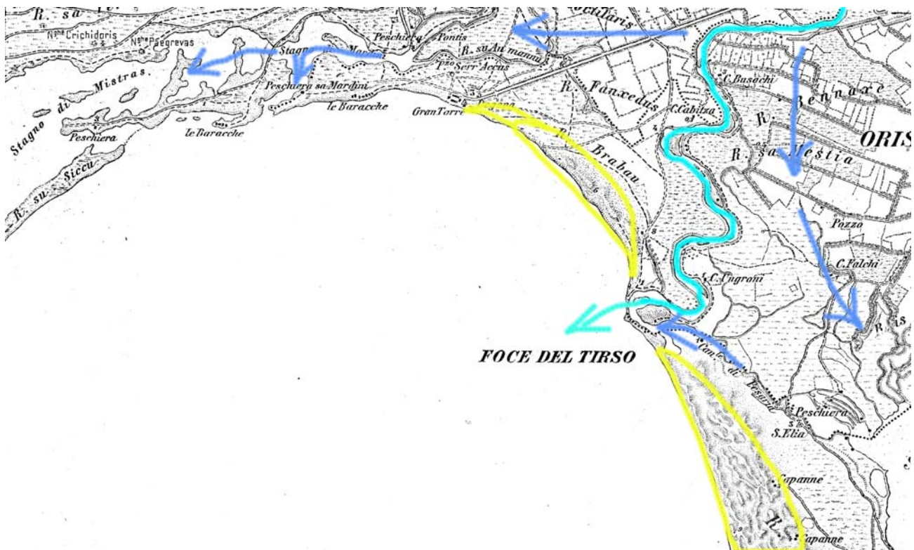
Mappa – IGM 1880 con schema del movimento delle acque ordinarie, di esondazione e dune
