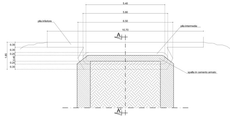
SEZIONE A - A' SPALLA TIPO "A"
