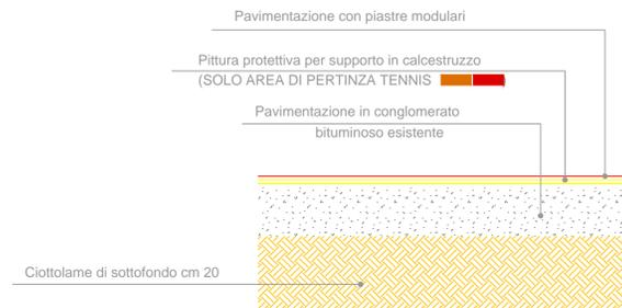
**PARTICOLARE SEZIONE TIPO - Scala 1:10
