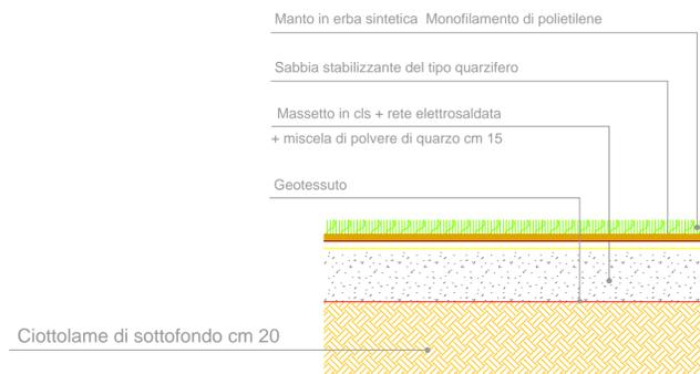
**PARTICOLARE SEZIONE TIPO - Scala 1:10
