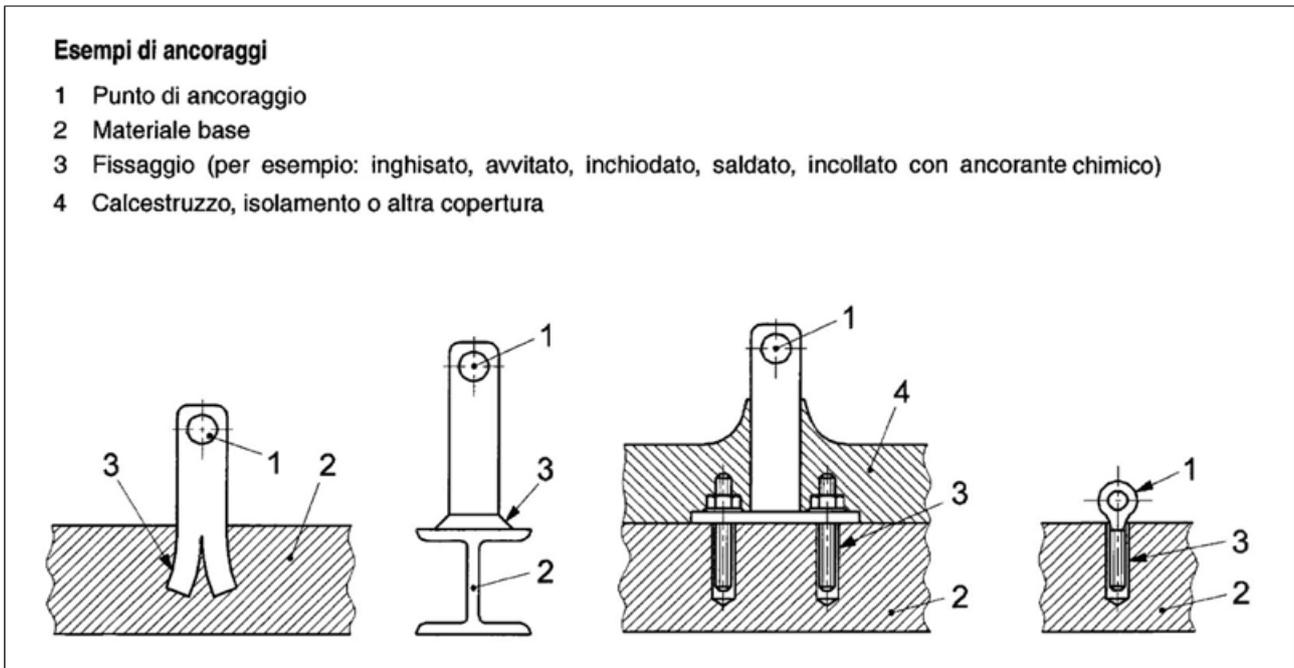
Quando il materiale base è a vista, come ad esempio travi di coronamento, parapetti e aggetti in cemento armato, coperture in lamiera, sarà indispensabile superare il pacchetto di copertura per individuare gli elementi strutturali in grado di assorbire i carichi determinati dall'arresto caduta.
