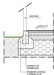
SEZIONE TIPO SOTTOFONDO
