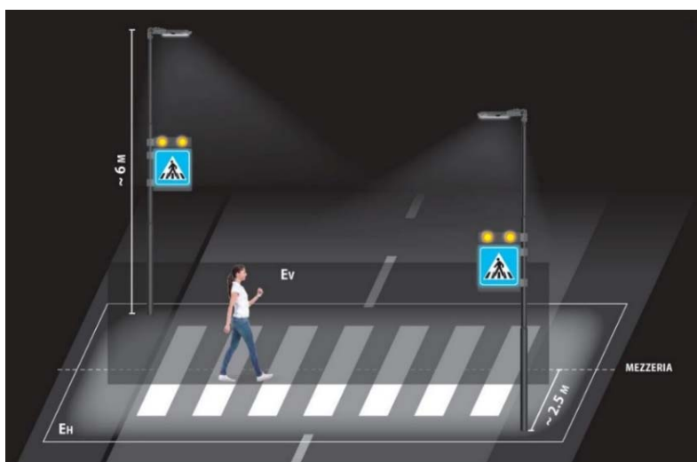
Sistema di illuminazione di attraversamenti pedonali tipo APL Smart
