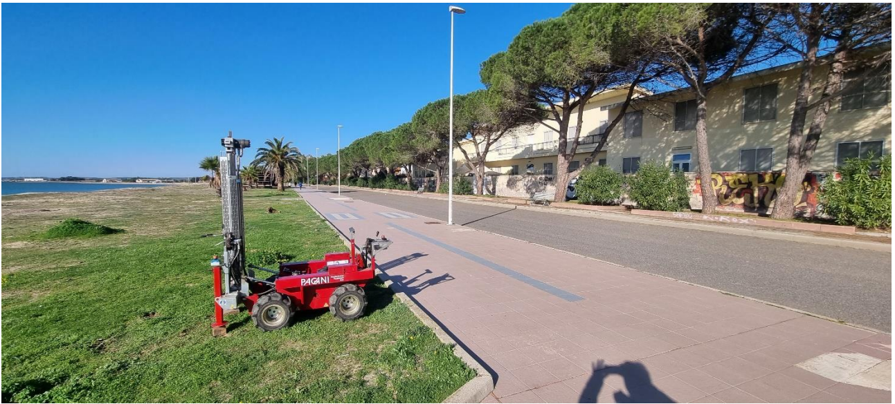
Foto 1: realizzazione prova penetrometrica Dpsh1.
