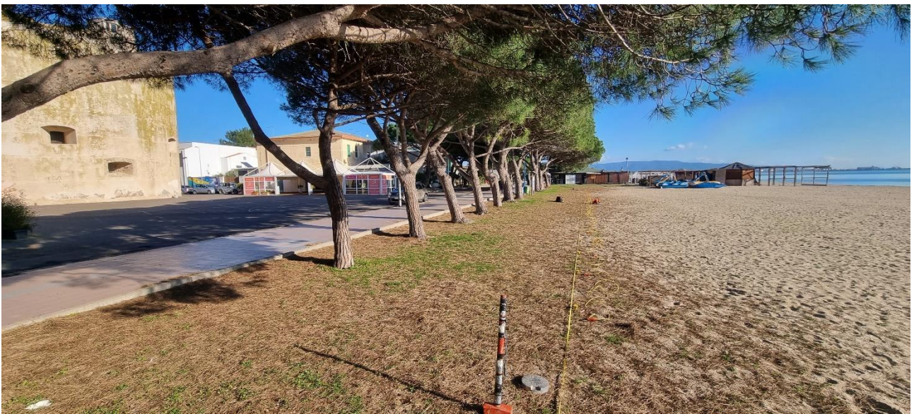
Foto 5: realizzazione indagine MASW (Geofono 24-Geofono 0).
