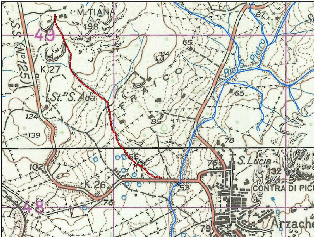
Figura 3: Esempio di elemento idrico presente nell' IGM-25VS e non presente nel reticolo DBGT\_10k ritenuto significativo a seguito di considerazioni di carattere idraulico e geomorfologico e corretto con DTM da rilievo GPS.
