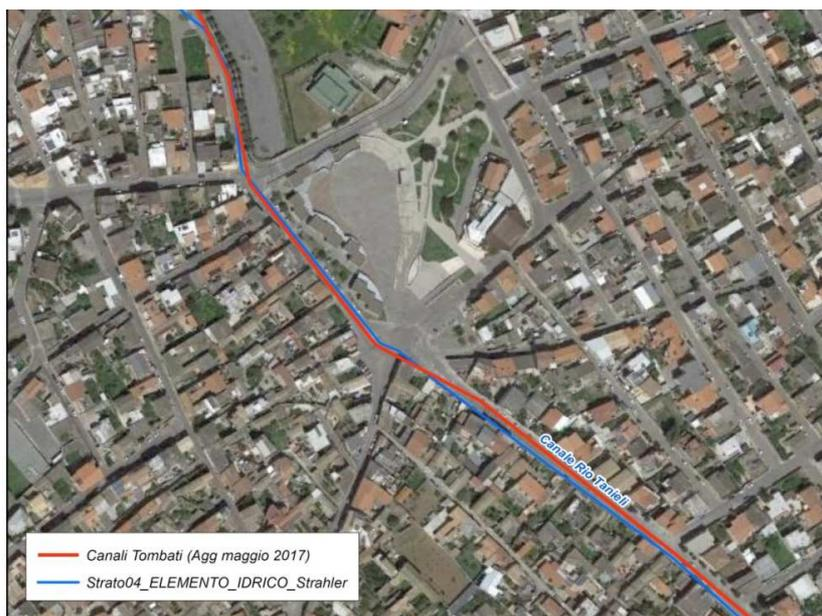
Figura 4: Esempio di un elemento idrico del reticolo DBGT\_10k che afferisce a un canale tombato
