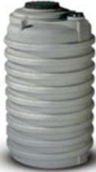
Fig. 1 : Fossa settica a tenuta in PEAD per interro dotata superiormente di foro e canna di ventilazione per garantire valori di pressione uguali a quella esterna
