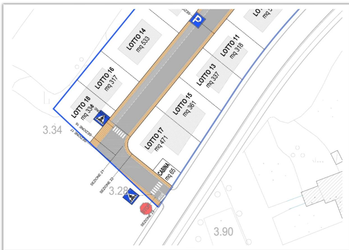
Figura 4: Nuova ubicazione della cabina di trasformazione
