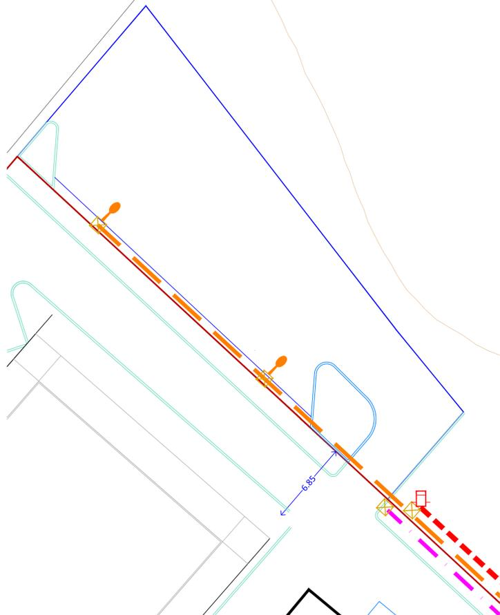
Ad angolo con la recinzione del complesso della Questura Prefettura si trova una cabina di trasformazione ENEL MT/BT. Il punto di consegna avverrà a bordo cabina e la rete si svilupperà nel viottolo di servizio su un cavidotto in corrugato da Ø 80 mm. La rete di pubblica illuminazione e dati si svilupperanno su cavidotti separati, sempre in corrugato, da 63 mm. Ogni 50 mt verranno posizionati dei pozzetti stagni di ispezione e incrocio
