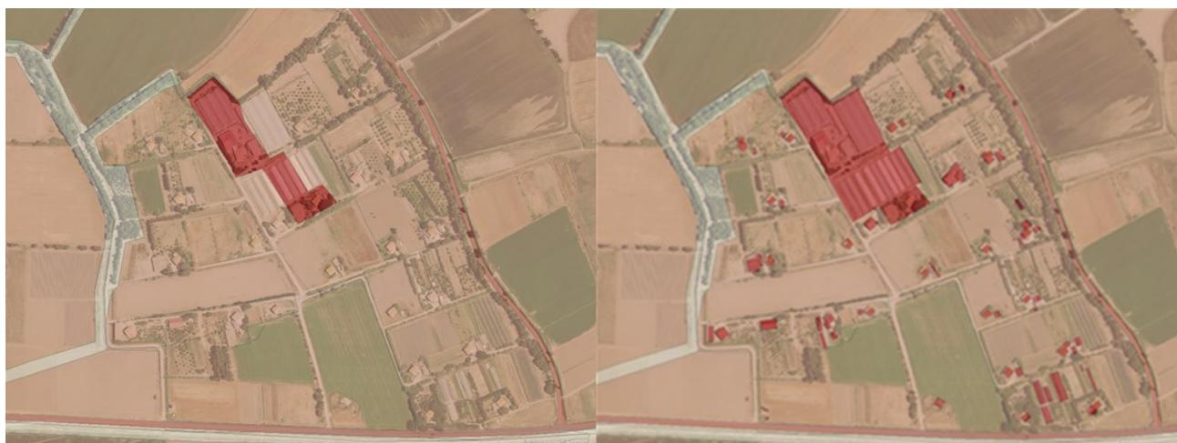
Figura 0.2 – A destra particolare della mappatura da PGRA del danno potenziale (le tonalità di rosso via via più scure indicano un aumento del danno potenziale) in località Pardu Accas, a sinistra l’elaborazione della medesima area prodotta dal Piano di Adattamento. Si nota come il PGRA individuasse solo una porzione delle aree dedicate alle colture in serra non tenendo minimamente conto dell’insediamento rurale sparso nell’intorno.
